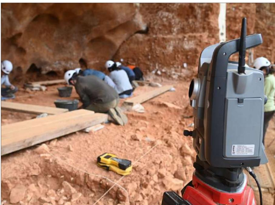
Trabajos en Galería, según yacimiento de la Trinchera. En primer plano una estación total que coordina cualquier hallazgo de manera automática. SANTI OTERO
