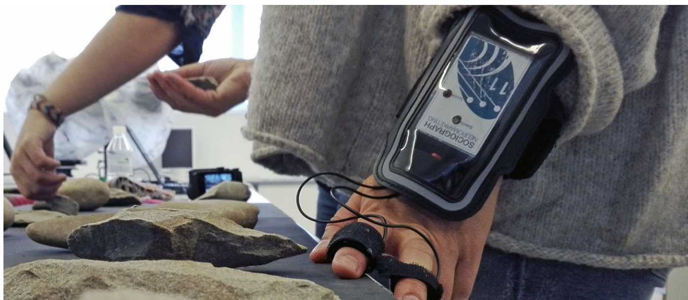
Dispositivo utilizado para medir la actividad electrodérmica durante la sesión experimental. Foto: Annapaola Fedato
